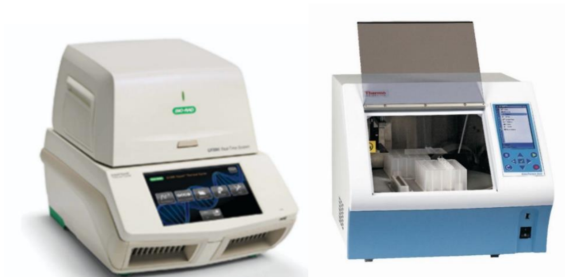
Hình 2.2. Máy sử dụng để thực hiện MPL-rPCR. CFX C1000 touch (trái) và Kingfisher Duo Prime (phải).
